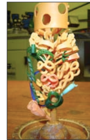
17- La cire est grappée avec d'autres pièces, identiques ou non
