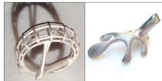
19- Séparation des pièces ainsi obtenues pour la finition et le polissage
